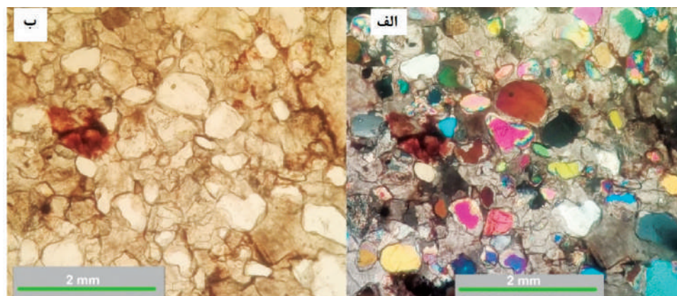
شکل ۷. الف) تصویر میکروسکوپی از رخساره سنگ‌های مختلط در نور پلاریزه، ب) دانه‌های کوارتز در زمینه میکرایتی به‌صورت شناور هستند و بعدها طی دیاژنز تبلور مجدد یافته است (نور طبیعی)
